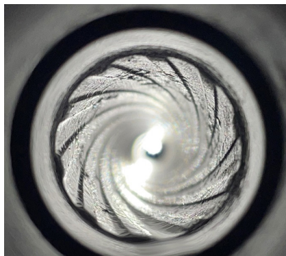
Рисунок 5. Вид канала ствола АМ-23 после стрельбы
