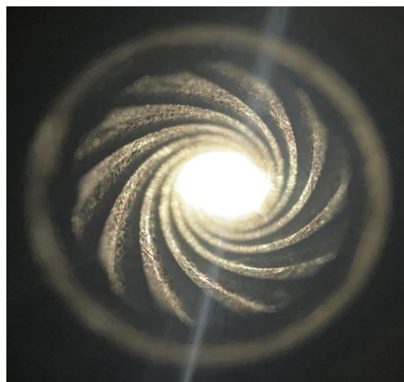
Рисунок 4. Вид канала ствола АМ-23 до стрельбы
